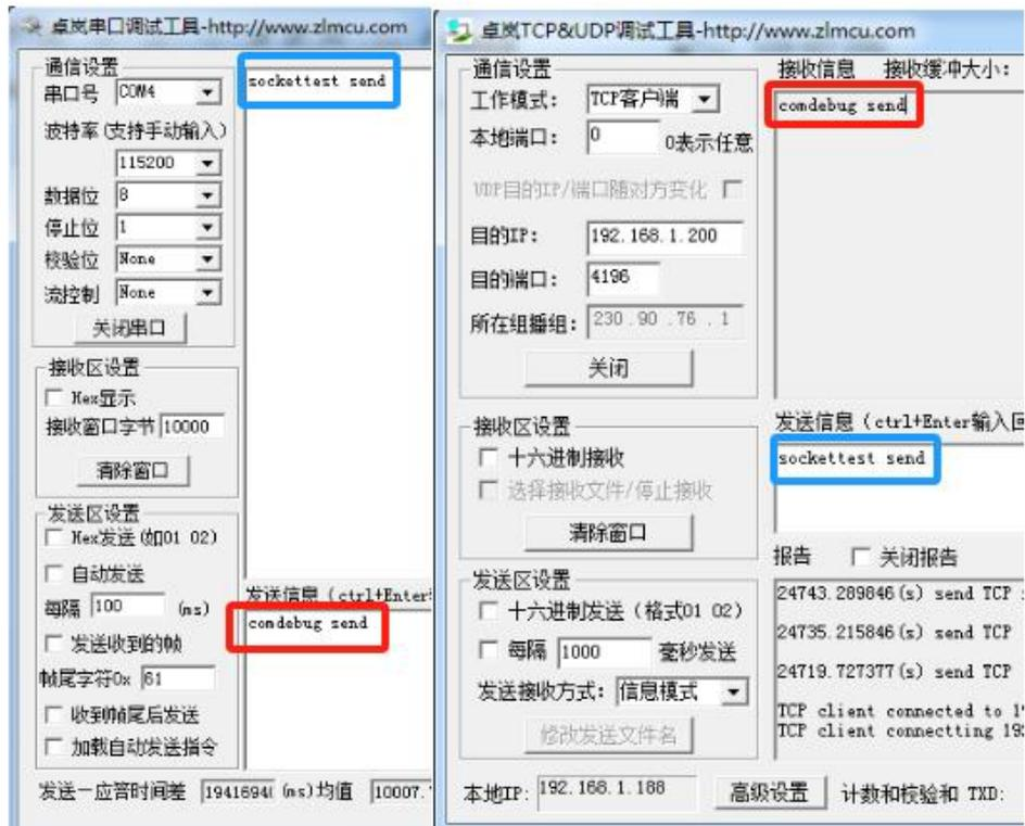
至此，我们就可以在串口和网络之间进行数据收发测试了，串口到网络的数据流向是：计算机串口->5107 串口->5107 以太网口->计算机网络；网络到串口的数据流向是：计算机网络->5107 以太网口->5107 串口->计算机串口。具体演示如下图所示：
