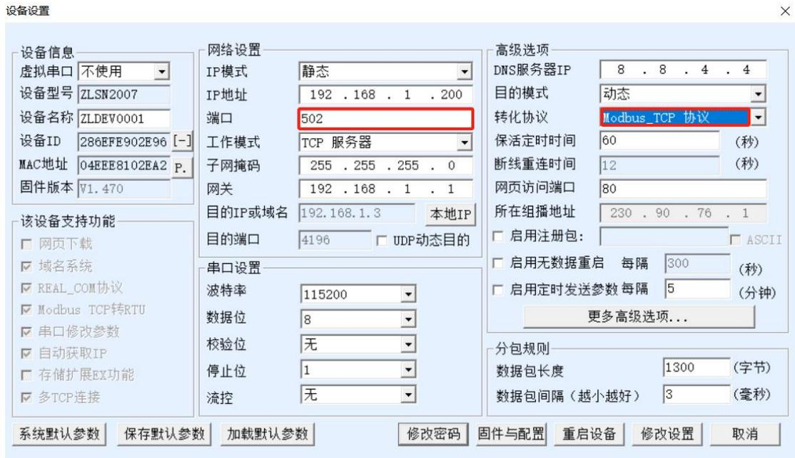
如果用户的 ModbusTCP 软件是作为从站 (Slave)，则需要在选择转化协议基础上，再将工作模式改为客户端，目的 IP 改为 ModbusTCP 软件所在计算机 IP，目的端口为 502，如图所示。ModbusTCP 做客户端。
