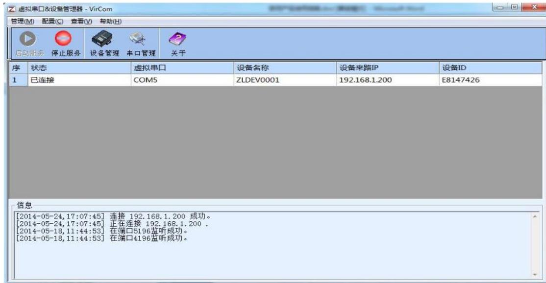
打开 ZLComdebug 来模拟用户的串口程序，打开 COM5(上面的虚拟串口)，另外再打开一个 ZLComdebug 来模拟一个串口设备，打开 COM4(硬件串口)。此时 COM5 发送数据链路如下：COM5→ZLVircom →串口服务器网口→串口服务器串口→COM4。反之，COM4 到 COM5 也能传输数据：COM4 →串口服务器串口→串口服务器网口→ZLVircom→COM5。如图所示双方发送和接收数据情况。如果将 COM4 换为用户串口设备，则 COM5 可以实现和用户设备的通讯。
