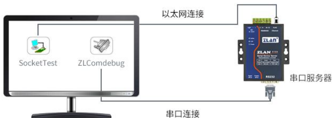
图 11 TCP 通讯示意图
